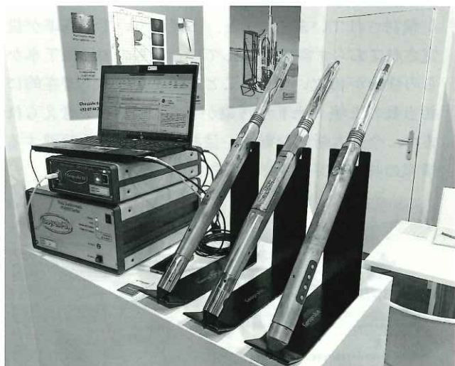
ジオプローブ先端に装着する各種ダイレクトセンシングプローブ
