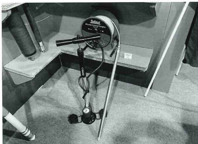
手押し空気ポンプを利用した地下水サンプラー （深度1200m地点からも採水可能）
