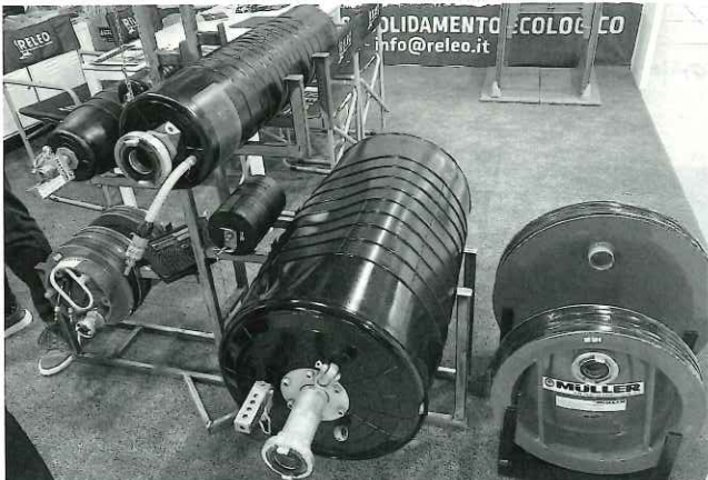
下水道管のバリアブルシステム（下水道管内に挿入、エアバックャーのように膨張させて、管路を遮断し、汚水の周囲への流出を防止する）
